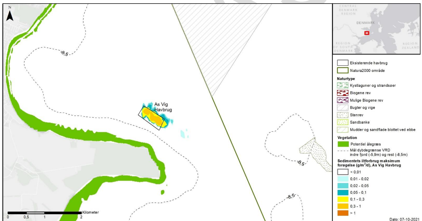
Figur 8-7 Maksimal ændring i gennemsnitligt ugentligt iltforbrug i sedimentet i 5-års perioden i forhold til den potentielle udbredelse af ålegræs (nutidsforhold). Maksimal ændring i gennemsnitligt ugentligt iltforbrug > 0,1 \text{ g O}_2 \text{ m}^{-2} \text{ dag}^{-1} angiver grænsen for påvirkning foranlediget af ændringer i sedimentets iltforbrug. Ålegræssets dybdegrænse er angivet som grænseværdier for god-moderat grænsen på hhv. 5,9 m og 8,5 m i "Hørsens Fjord, indre" og "Hørsens Fjord, ydre". Øverst: oversigtskort med hele Natura 2000-område 56. Nederst: zoom på området omkring As Vig Havbrug.
