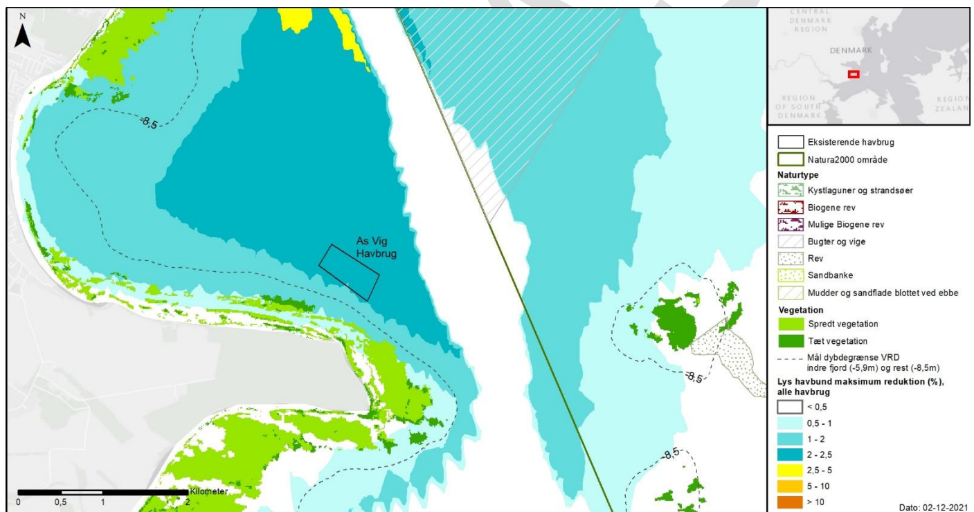
Figur 8-21 Maksimal procentvis ændring i lys ved bunden (for produktionsperioden) i lysintervallet 17,5 - 300 \mu\text{E m}^{-2} \text{s}^{-1} , i forhold til udbredelsen af bundvegetation. As Vig Havbrug kumuleret med omkringliggende havbrug. Det bemærkes, at satellitdata kun dækker ud til dybde på 7 m. Ændringer > 2,5% angiver grænsen for påvirkning foranlediget af ændring i lys ved bunden. Ålegræssets dybdegrænse er angivet som grænseværdier for god-moderat grænsen på hhv. 5,9 m og 8,5 m i "Horsens Fjord, indre" og "Horsens Fjord, ydre". Øverst: oversigtskort med hele Natura 2000-område 56. Nederst: zoom på området omkring As Vig Havbrug.
