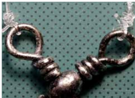
Knuden til højre er bundet med en stiv og kold nylonline 0.90 mm nylonline. Knuden til venstre bundet med samme line, der er dyppet i kogende varmt vand.
