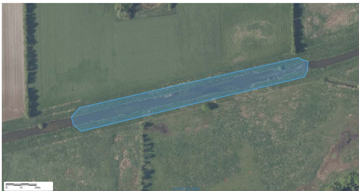
Figur 3. Placering af to stenstryg i Gels Å hhv. lige op- og nedstrøms Toftlundvej. Stenstrygene kunne ud- lignes og derved få et mindre fald for derved at genskabe bedre fiskepassage samt større gyde- og op- vækstområder for en række fiskearter.
